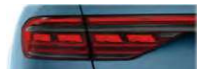
後方車輛靠近車尾時， OLED 尾燈呈現之模式
