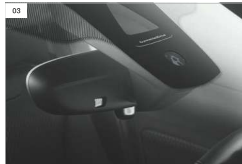
[ 03 ] 雨珠感應器，會頭燈自動啓閉控制系統，可自動開啓雨刷和近光燈。
