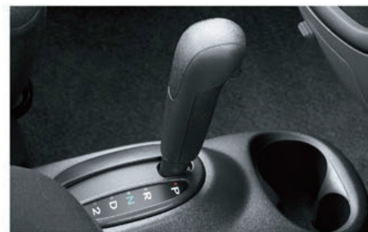
四速電子控制自動排檔+爬坡控制系統 (附OD超速傳動裝置)
