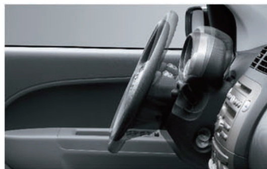
電動輔助方向盤+獨立駕駛儀表 可同時調整，提供最佳安全視野
