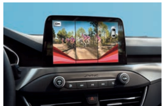
雙模式倒車顯影輔助系統 (一般及 180 度廣角)
