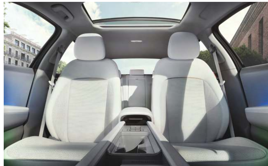
電動玻璃天窗 (附電動遮陽簾 / 防夾裝置)
