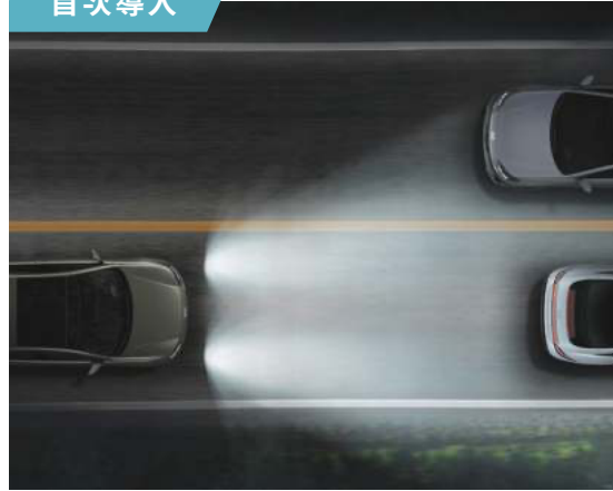
IFS 智慧型動態頭燈照明系統
