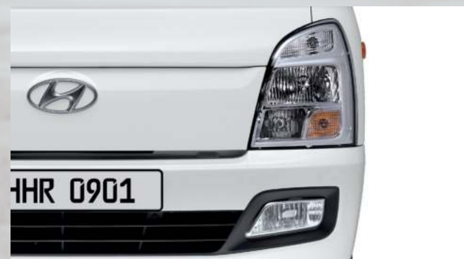
上：四合一晶鑽頭燈組 (含日行燈／自動啟閉頭燈) 下：前霧燈
