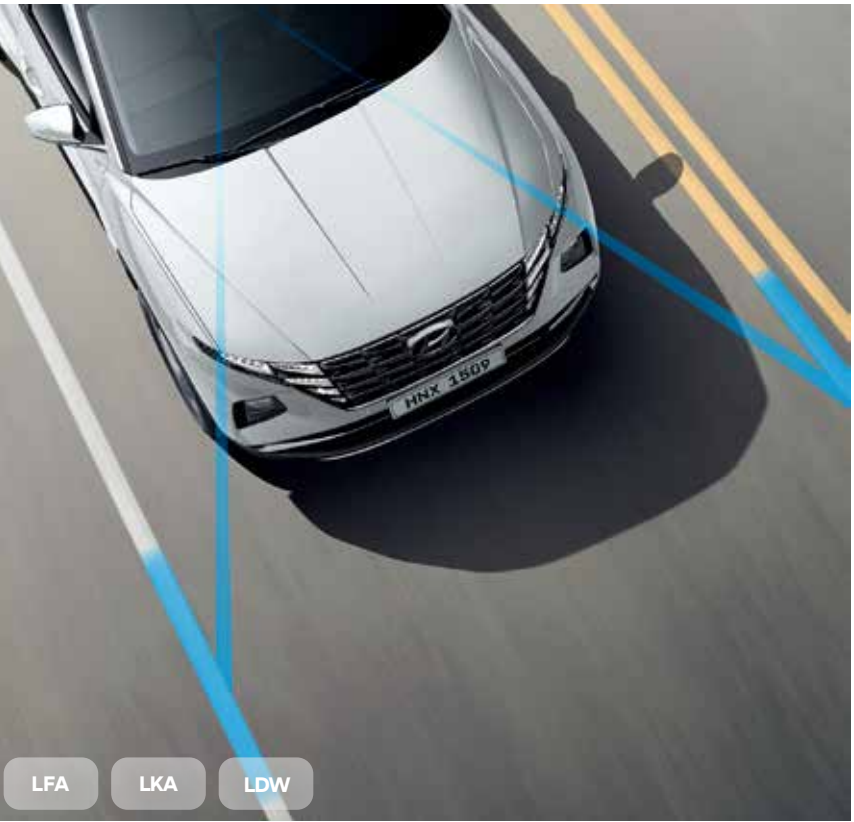
LFA 全速域車道維持輔助系統 / LKA 車道偏移輔助系統 / LDW 車道偏移警示系統 透過攝影機主動偵測道路標線，將車輛維持車道中心行駛，提升駕駛的便利性。
