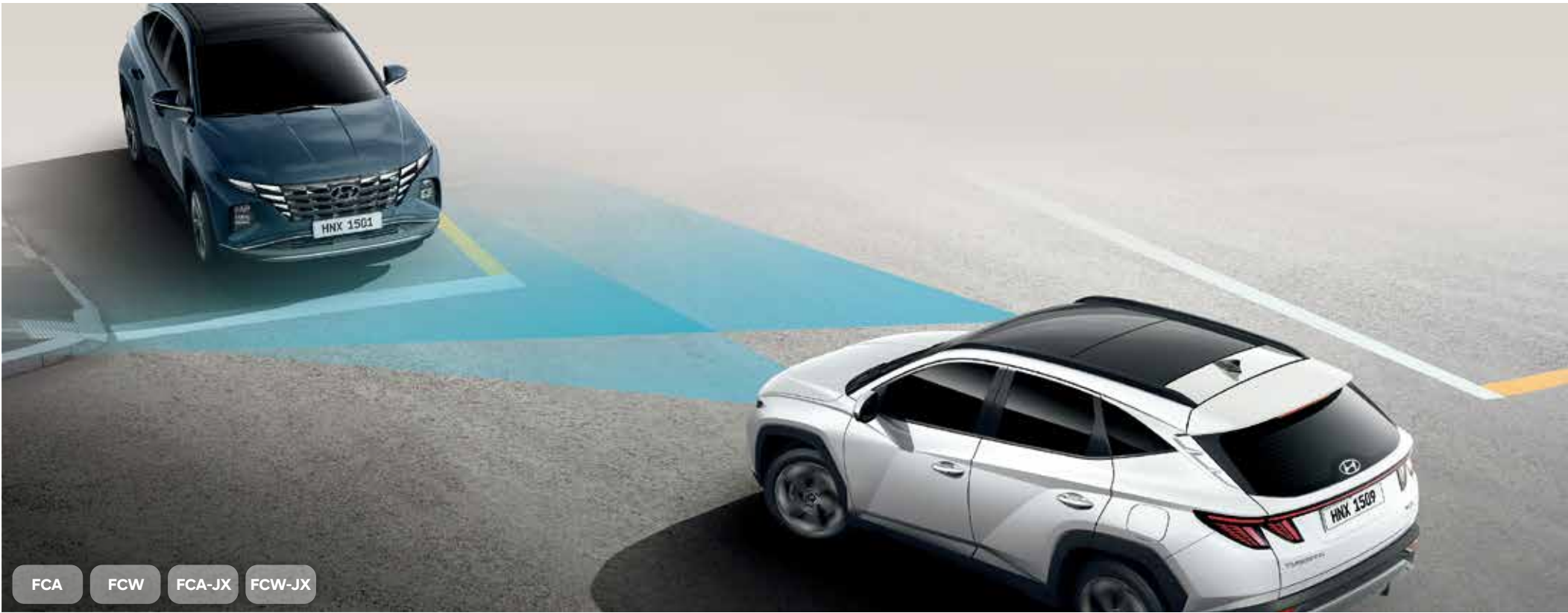
FCA 前方主動煞停輔助系統 (含汽車 / 行人 / 騎士) / FCW 前方撞擊警示系統 / FCA-JX 對向來車路口煞停輔助系統 / FCW-JX 對向來車路口安全偵測系統 當駕駛者於十字路口撥打左側方向燈，系統自動偵測到可能與對向來車於路口發生碰撞時，會以警示音、儀表板警示圖示來提醒駕駛，若碰撞風險增加時，系統將自動啟動輔助煞車，降低意外發生。
