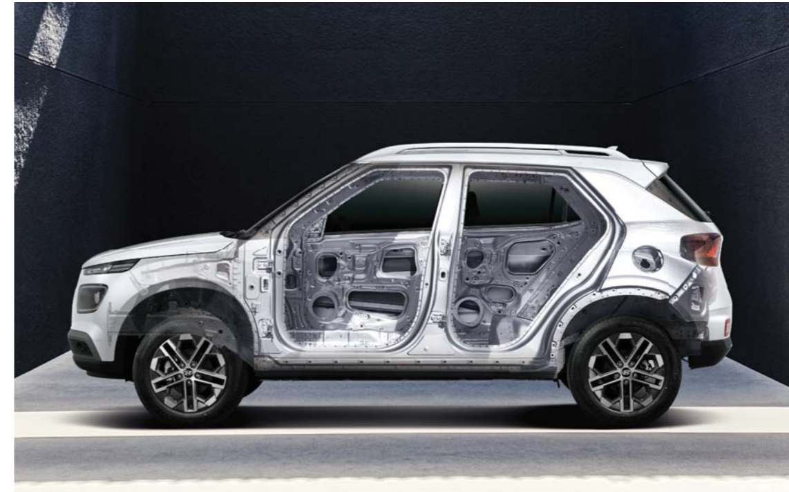
62%高剛性鋼材 ( 46% AHSS 先進高剛性鋼材 + 16% HSS 高剛性鋼材 )
