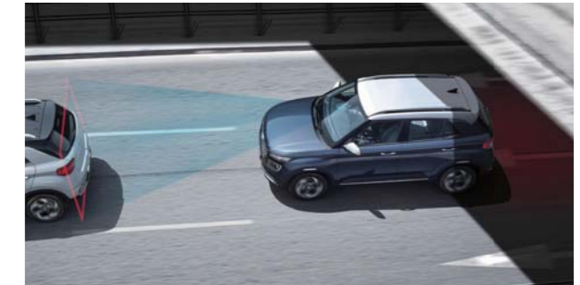
SCC 智慧型主動車距維持系統 / FCW 前方撞擊警示系統 FCA 前方主動煞停輔助系統 ( 含行人偵測 )
