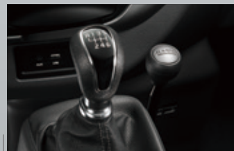
分時四輪傳動系統 (附2H/4H/4L切換)
