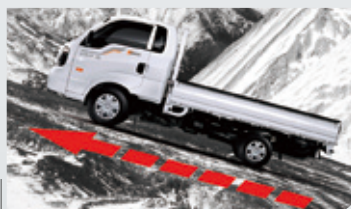
HAC上坡起步輔助系統
