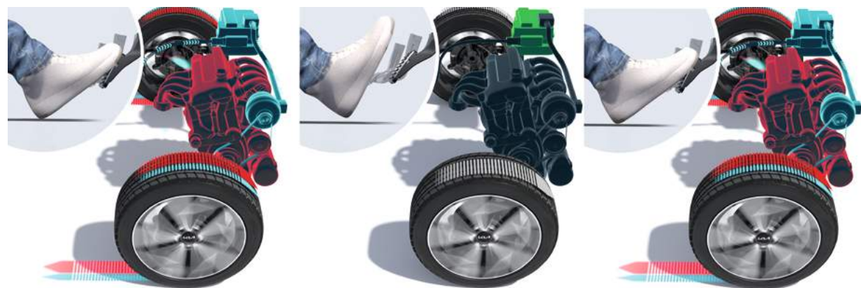
Mild Hybrid滑行功能運作示意圖
