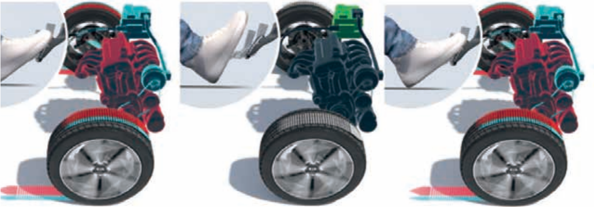
滑行功能模式 Mild Hybrid滑行功能運作示意圖
