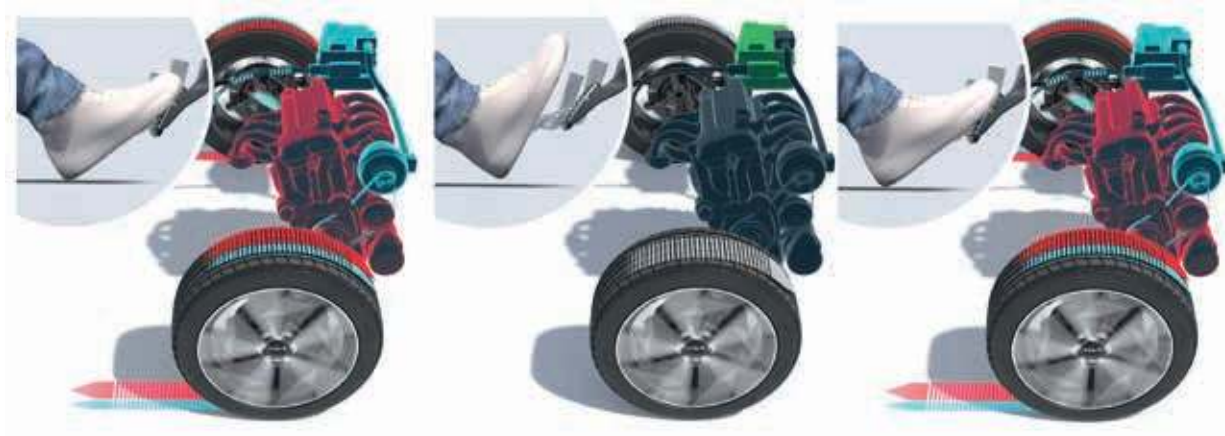
Mild Hybrid滑行功能運作示意圖
