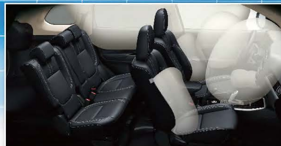
7-SRS環艙氣囊 (本圖片為氣囊展開示意圖，內裝造型與配備請以規配與實車為主。)
