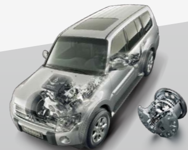
AWC全輪控制系統/後差速器鎖定功能 整合中置引擎車體設計、SS4-II四輪傳動系統、 四輪獨立懸吊系統、ASTC主動車身穩定循跡控制 系統，創造PAJERO優異的駕駛操控表現。 *本圖片為AWC全輪控制系統示意圖，其他配備請以規配 表為準
