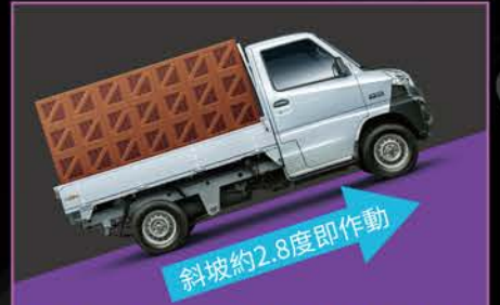
斜坡約2.8度即作動 上坡時放開煞車起步瞬間，車輛不後滑(2秒內)防止意外發生
