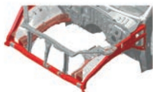
Посилені елементи каркасу моторного відсіку
