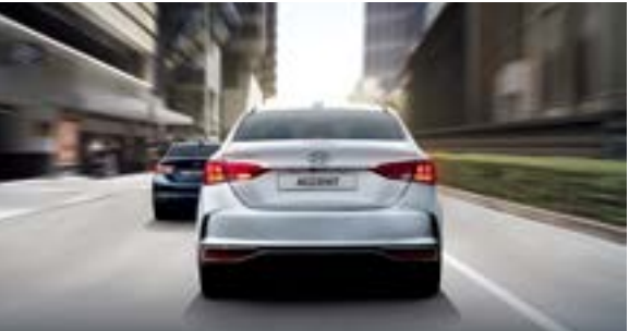
Đèn báo phanh khẩn cấp ESS Khi phanh gấp, hệ thống đèn báo phanh khẩn cấp ESS trên Accent sẽ hoạt động phát tín hiệu liên tục, giúp cảnh báo xe phía sau về tình trạng xe bạn, đảm bảo an toàn hơn khi vận hành.
