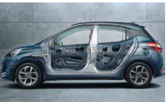
Hệ thống khung mới cứng vững hơn với thép cường độ cao AHSS
