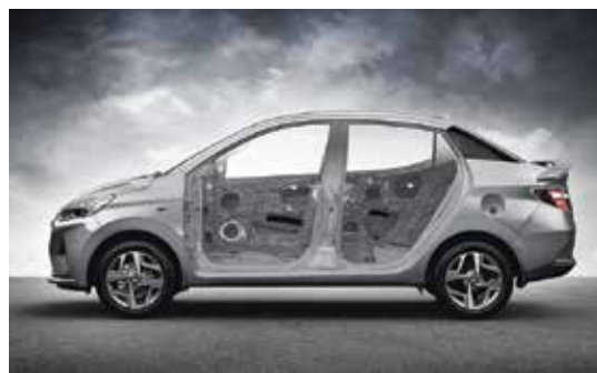
Hệ thống khung mới cứng vững hơn với thép cường độ cao
