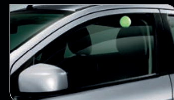
Cửa kính chỉnh điện, 1 chạm lên xuống kính và chức năng an toàn chống kẹt phía người lái
