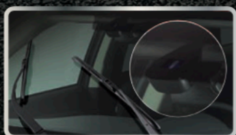
Cảm biến bật/tắt đèn chiếu sáng và gạt mưa tự động
