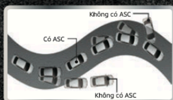
Hệ thống cân bằng điện tử (ASC)
