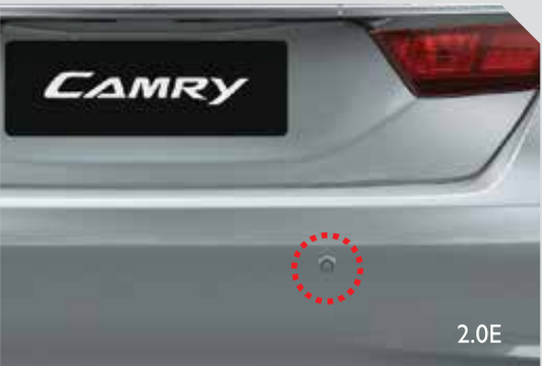
CẢM BIẾN LÙI / CẢM BIẾN GÓC Cảm biến lùi (2.0E) và cảm biến góc (2.5Q và 2.5G) giúp xác định vật cản khuất tầm nhìn, phát tín hiệu cảnh báo hỗ trợ người điều khiển đánh lái phù hợp để lùi hoặc đỗ xe an toàn.
